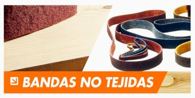
Estas bandas para trabajo pesado proporcionan un desempeño superior que los abrasivos comunes. Su combinación única de fibras sintéticas y partículas abrasivas produce un material abierto y flexible. Pueden usarse para eliminar corrosión y quitar pintura vieja y capas de barniz sin modificar la base original de la superficie. Los grados disponibles son Fino (azul), Medio (granate) y Grueso (café).
